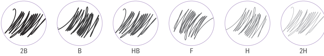
Representación circular de los valores del lápiz según su dureza (9H-9B).
