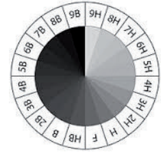
Representación circular de los valores del lápiz según su dureza (9H-9B).
